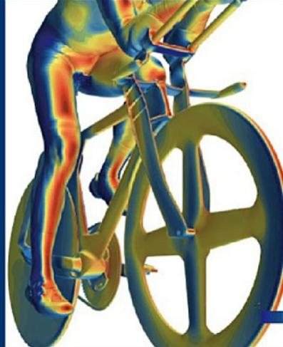
TCMが開発した競技自転車V-IZU TCM-2(上・左)はCFDや風洞を用いて設計。フィンのついたV字型フォークや薄型フレームなど空力性能が追求された。また、今年12月に月面へ旅立つ「HAKUTO-R」(下)の筐体にはカーボンモノコック構造を採用。カーボン素材の知見と、複雑な造形を成形可能であるCFRPがあらゆる分野の可能性を広げている。
