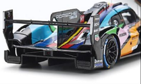
CLRから25年分の進化を経た現代WECスポーツカーの空力を963のリヤの造形に見ることができる。センターステーを廃して乱流を減らしたリヤウイングに複層的なフロアディフューザーなど、1/43スケールのモデルとは思えない再現度に驚く。
