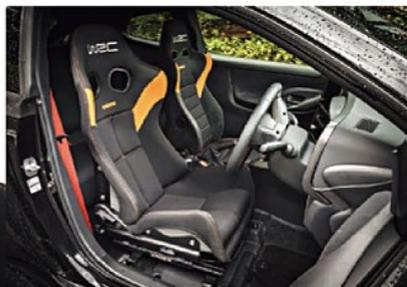
今回の別注モデルは4種。フルバケットの「ZETA IV」と「ZETA IV VERIA」、フルバケット並みのホールド性を追求したセミバケットシート「GIASⅢ (Low)」、コンフォートセミバケットシート「ERGOSTER」が用意される。デザインは共通なので、運転席と助手席でモデルを変えて装着することも可能だ。
