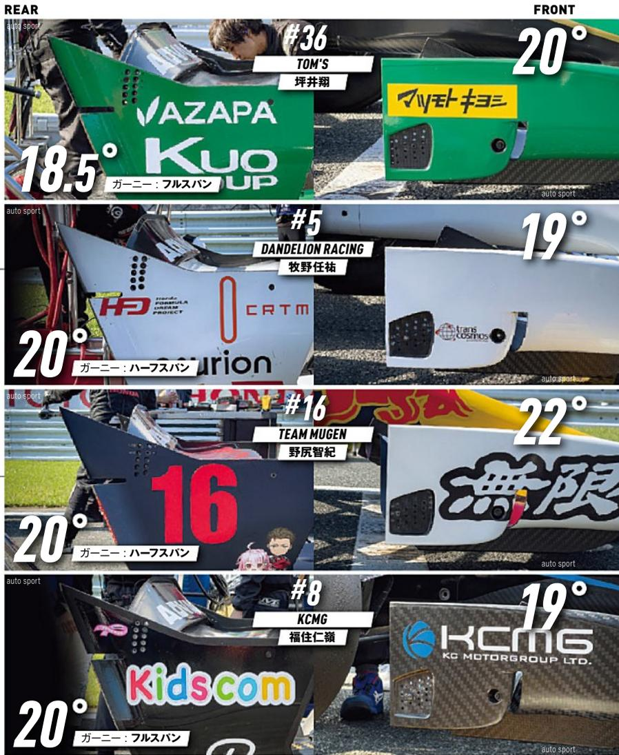
第6戦での野尻車はフロントウイングの角度がかなりついていて、リヤは逆に角度が寝ていた。また、リヤのガーニーはハーフスパンと、ドラッグを減らす方向の仕様だった。その理由について野尻は「アンダーステアが強いからフロントをつけ、その状態でリヤもつけてしまうとストレートが伸びないので寝かせました」と説明する。
